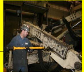
スキッドステアローダー、シザーリフトのピン抜き作業
